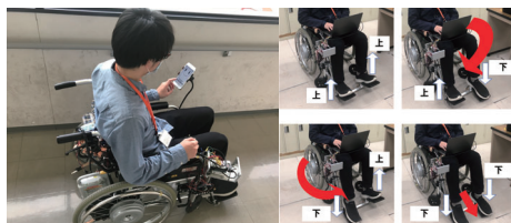
車椅子(カワムラ KA22-40SN)に車椅子用電動ユニット(YAMAHA JW-1)を取り付けたシステム
