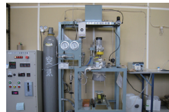
燃料を合成するFT反応の試験装置
