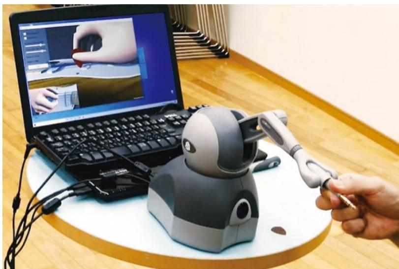
図 D.1 3次元触覚/力覚インターフェースデバイスを用いたピッキング奏法練習ツール
