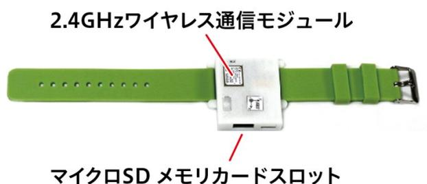
図 3.14 腕時計型ワイヤレス運動センサデバイス
