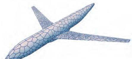
(図2) ポロノイ分割を適用した胴体ならびに主翼の構造検討案
