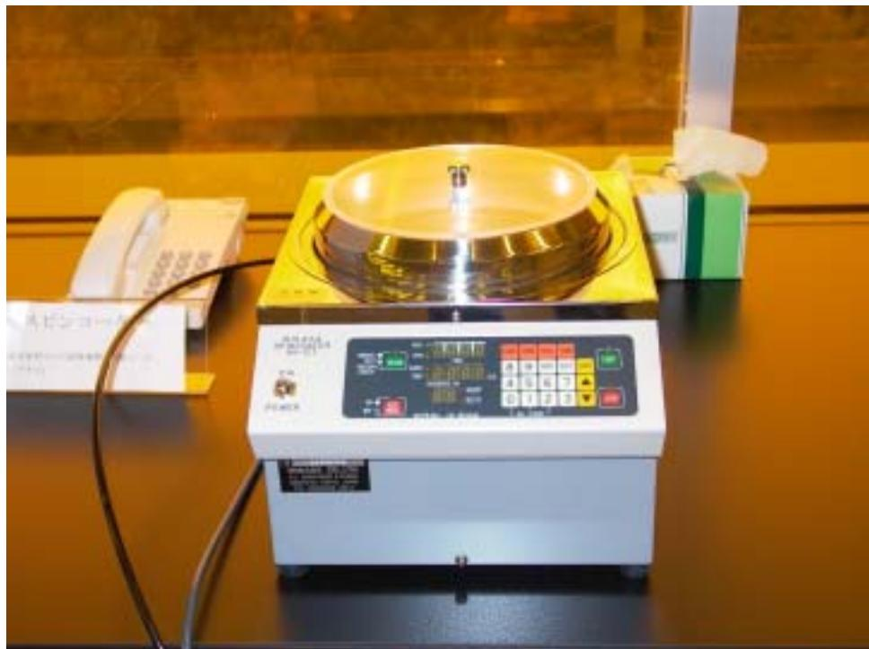
半導体製造のホトリソ工程においてシリコンウエーハ、ガラスなど平坦な基板にフォトレジスト等を滴下し、基板表面に数ミクロンくらいのフォトレジスト膜を均一に形成させる装置です。
