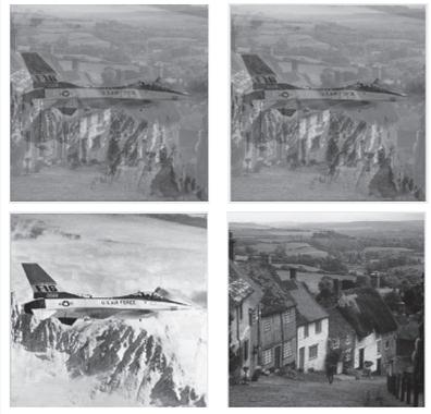
信号源が互いに統計的に独立であるという仮定だけで、混合信号から個々の信号源信号を分離する手法とその性能について研究しています。画像の種類、混合過程、混合画像の個数を変えて分離性能、復元画像の品質 PSNR、SSIM、計算手順の反復回数、演算時間 CPU time を、従来手法 PARAFAC、ACDC 等と比較しながらシミュレーションと実環境のデータの両面から調べています。
