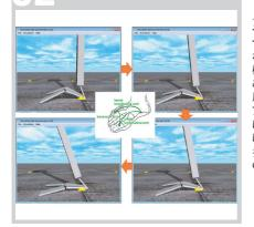
人間の足部にはアーチ構造が存在し、 そのアーチ構造が歩行時の衝撃吸収、 つま先を使った蹴り出し動作、重心移動 などに役立っています。そのようなアーチ 構造を2足歩行口ボットに導入するた めに、アーチを模擬した足部モデルを 用いた動力学シミュレーションによって アーチ構造の歩行動作への影響を明らか にします。シミュレーションの結果をもと に、不整地に対して人間のような安定な 歩行動作を生成できるような足部形状 の設計を行います。
