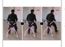
など、さまざまなセンサを用いて人の運動 を計測し、運動の分析、解析を行います。 睡眠時の寝返りがしやすくなるような 枕高さ調節のためのモーションセンサや 筋電センサによる寝返り動作解析の研究 や、モーションセンサを用いて新しい歩行 補助器使用時の歩行動作を計測しその 特徴を分析する研究などを行っています。
