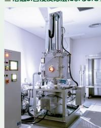
CMC製造の重要な課題 図るために、溶融状態に あるSiをSiC繊維と炭素 の予備成型体 (プリフォー ム体) 中に含浸し、SiC繊 維の特性を劣化させるこ となく高性能なSiC/SiC を作製する技術を開発し
